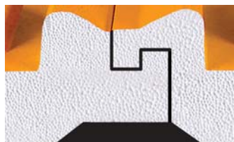
Sottocoppo UNICO Sezione frontale
